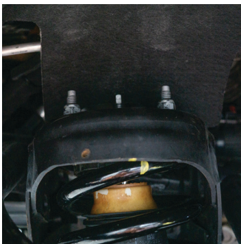
Fig. 17: Mount the top hat nuts.
